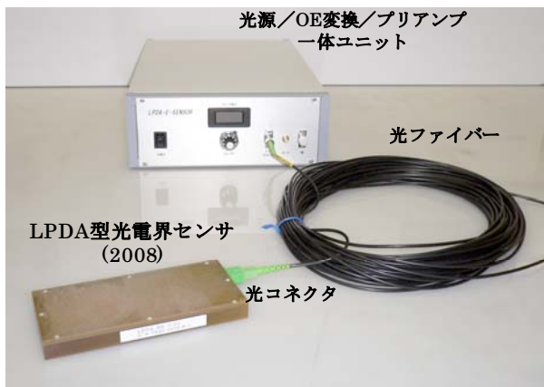
図 5 LPDA 型光電界センサ(2008)
